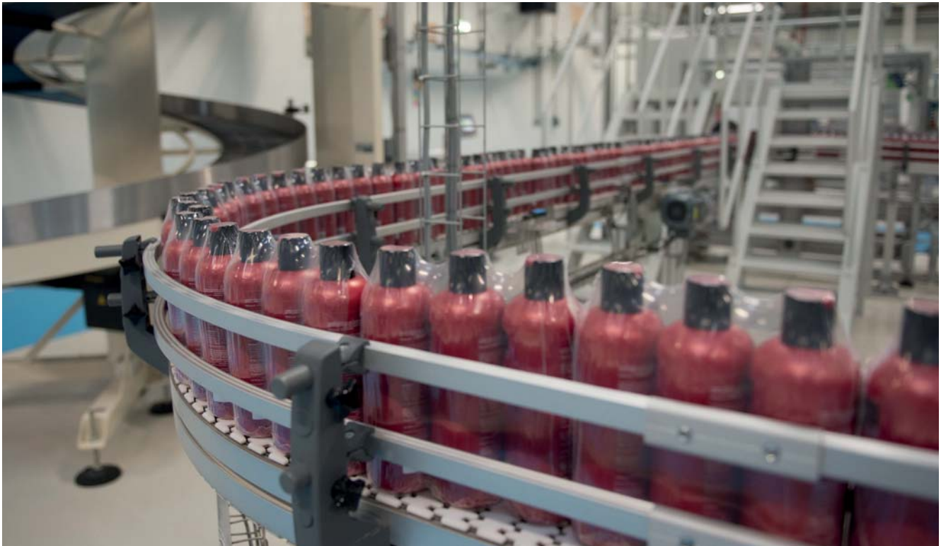
Wenn die gleiche Anlage mit einer optimalen Akkumulation ausgestattet wird, kann die Auswirkung kleiner Stopps auf die Gesamtanlagenleistung minimiert werden. © Sidel
