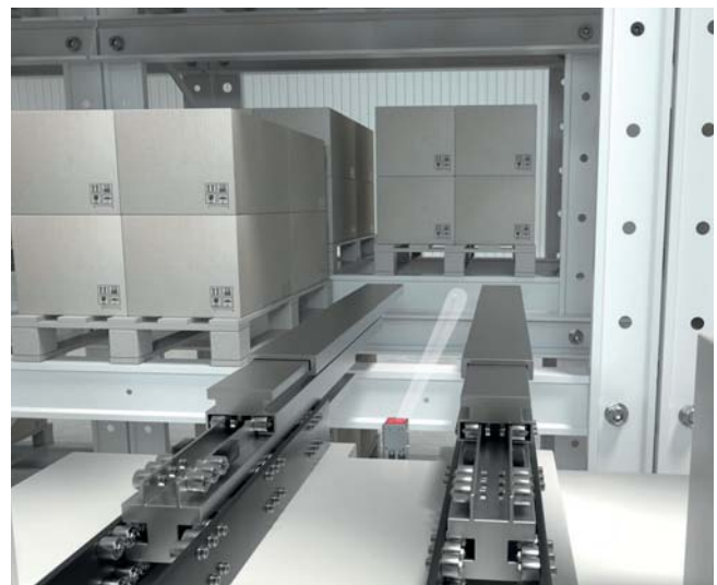
Abb. 5: Fachfeinpositionierung – doppeltefach Positionierung mit IPS 400i.
