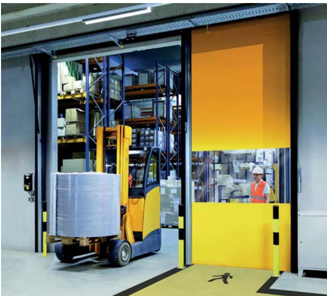
Abb. 1: NOVOSPRINT Duo verfügt über zwei unabhängig voneinander ansteuerbare Torflügel in einer Toröffnung. Dabei ermöglichen sie die sichere Trennung von Fahrzeug- und Personenverkehr oder können bei Bedarf eine zweispurige Staplerfahrbahn erzeugen. Und wann immer Sie die gesamte Torbreite benötigen, können Sie per Knopfdruck auch beide Torflügel gleichzeitig aufrollen. Das NOVOSPRINT Duo lässt sich jederzeit bei bestehenden Gebäuden nachrüsten und erspart oft den teuren Einbau einer separaten Personentür. © Butzbach GmbH
