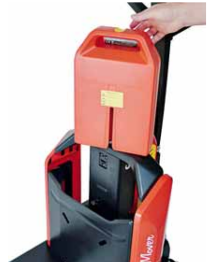
Die Lithium-Batterie des „Mover“ wiegt nur 4,5 kg und lässt sich in 2 s, verspricht der Hersteller. Foto: Logitrans
