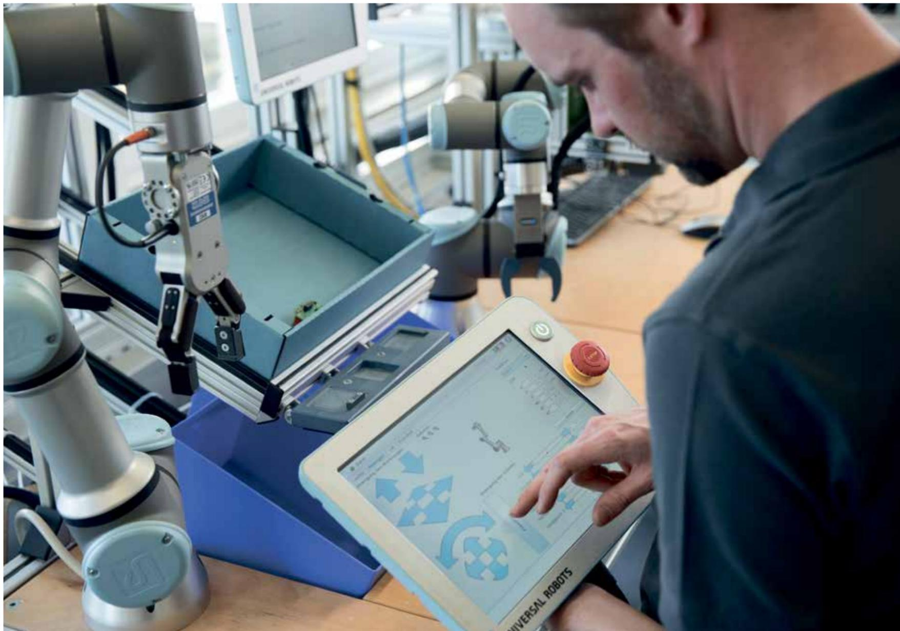
Kollaborierende Roboter dienen nicht nur dazu, schwere Lasten zu bewegen. Sie eignen sich auch für Arbeiten, die Fingerfertigkeit erfordern – wie etwa das Greifen von kleineren Teilen. ©UR
